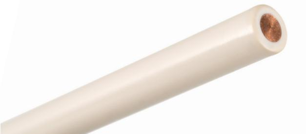
**绝缘线：**这款 PEEK 挤出件是一种理想的磁铁或电机绕组绝缘材料，适用于各种机电设备。PEEK 绝缘线可在高达 500 °F (260 °C) 的持续使用温度下保持优异的性能，此外还具有出色的耐磨性、耐化学腐蚀性、耐电强度。
